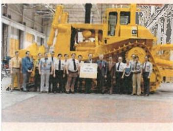
Vor gut 40 Jahren revolutionierte der D10 durch sein Delta-Laufwerk mit hoch gesetzten Antriebsrädern den Kettendozer-Markt. Noch immer entspricht es dem Stand der Technik.
